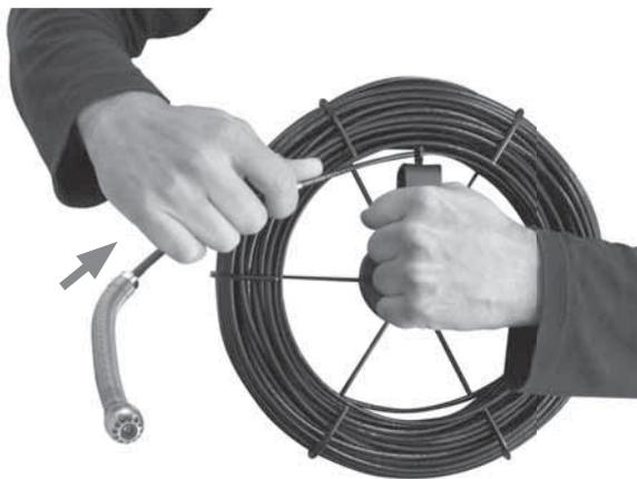
**!** O cabo não deve ser enrolado através da rotação da bobina.
