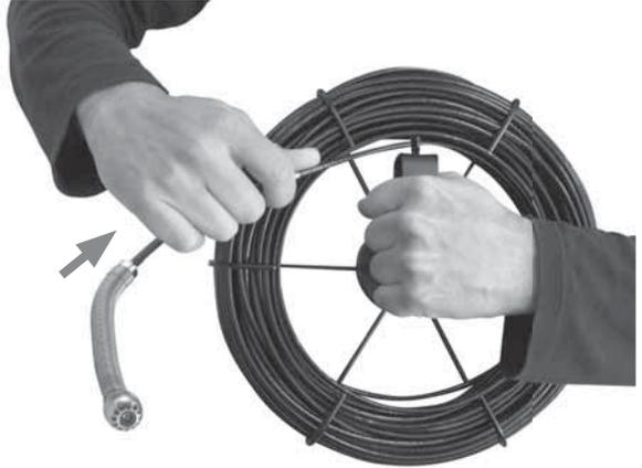
**!** Ne pas enrouler le câble en tournant le treuil.
